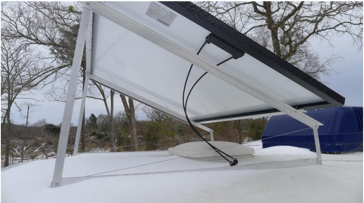
REAR OF THE PANEL UP TO MAXIMIZE THE SOLAR YIELD DURING THE LATE FALL/WINTER/EARLY SPRING TIMES WHEN THE SUN IS ON A MUCH LOWER TRAJECTORY. WHERE WE ARE PARKED NOW THE PANEL IS FACING NORTH SO I KEPT THE 8"
